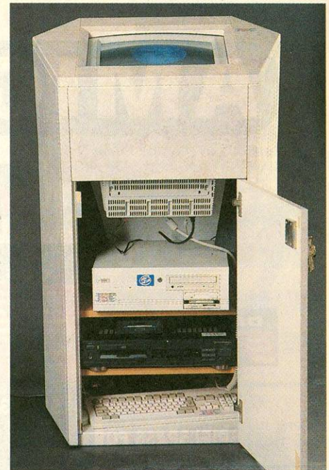
Innenansicht: Der »alte« ProTower mit stehpultförmigem Gehäuse, Touchscreen, Amiga 4000 und CDTV
